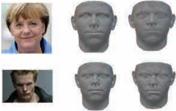
〈그림 2〉 3DMM 기반 방식과 템플릿 기반 방식의 비교. (좌) 입력영상, (중) 3DMM 방식으로 모델링한 결과 [36] , (우) 템플릿 방식으로 모델링한 결과 [27] . 음영 정보를 결합함으로써 템플릿 기반의 방식은 얼굴의 세부묘사를 더 잘 할 수 있다.
