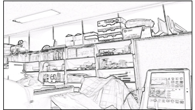
그림 2. 스마트폰에서 Gaussian blur와 Sobel 필터를 이용한 실시간 영상처리 결과.
